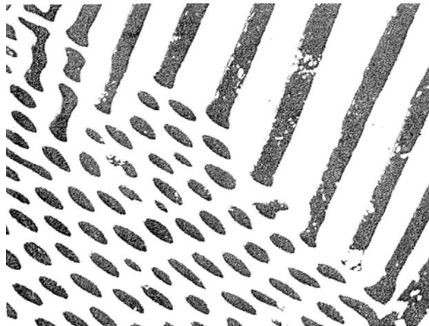
شکل ۹: ناحیه یوتکتیکی از شکل ۸ با بزرگنمایی بیشتر. طبیعت میله‌ای شکل آستنیت در لدبوریت کاملاً دیده می‌شود. آستنیت
