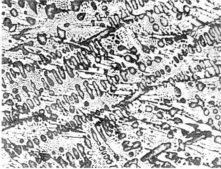
شکل ۴: تصویر میکروسکوپی چدن سفید هیپویوتکتیک، نواحی پرلیت دندریتی شکل (آستنیت اولیه) و یوتکتیک لدوریتی کاملاً
