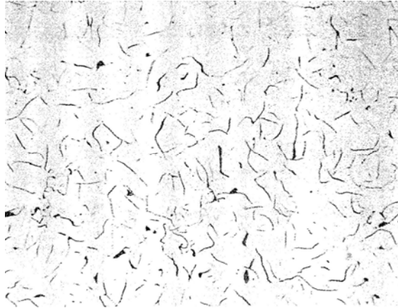
شکل ۱۱: تصویر میکروسکوپی نمونه چدن خاکستری در شرایط پولیش شده (نمونه اچ نشده است). به توزیع یکنواخت ورقه‌های
